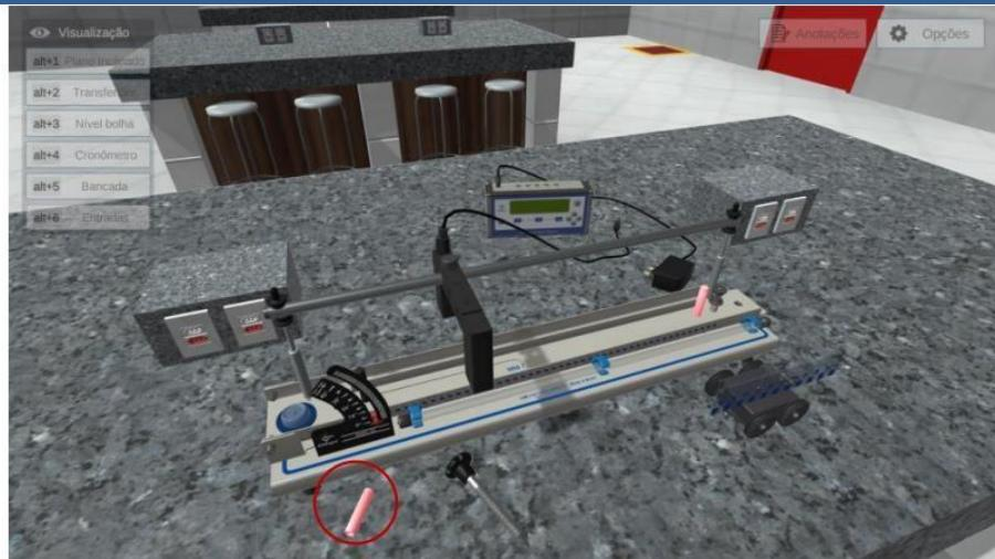
5. Posicione o fuso elevador, clicando com o botão esquerdo do mouse sobre o fuso e arrastando-o para uma das posições em destaque. Na figura abaixo, a posição destacada em verde é para pequenas inclinações e a posição destacada em amarelo é para grandes inclinações. Neste experimento usaremos a posição para grandes inclinações.
