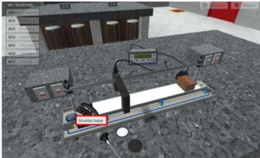
Ajuste a posição do sensor para a distância desejada. Para isso, clique sobre o sensor e arraste o mouse. Perceba que, no canto inferior esquerdo da tela, surgirá uma janela com a escala graduada do plano inclinado e a indicação da posição do sensor. Coloque-o na posição 300 mm da régua.
