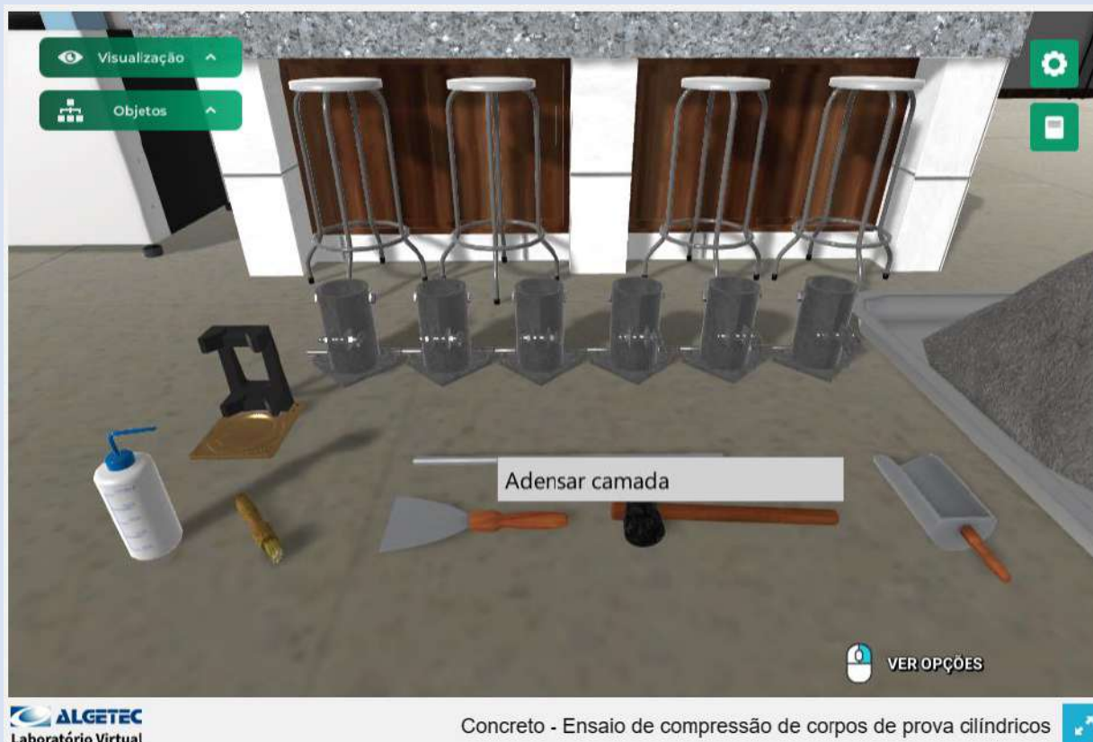
Figura 6 – Adensamento da camada da amostra no molde.
