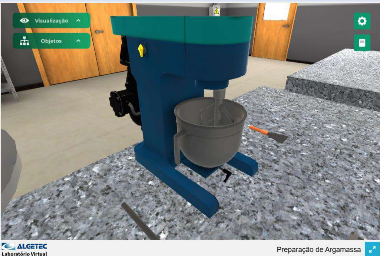
Figura 3 – Vista geral da argamassadeira.
