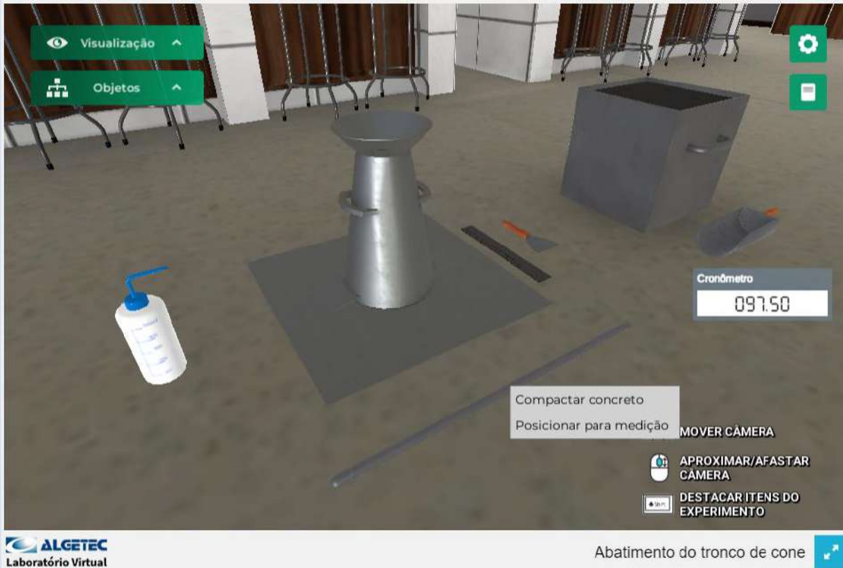
Figura 4 – Haste de compactação e de medição.
