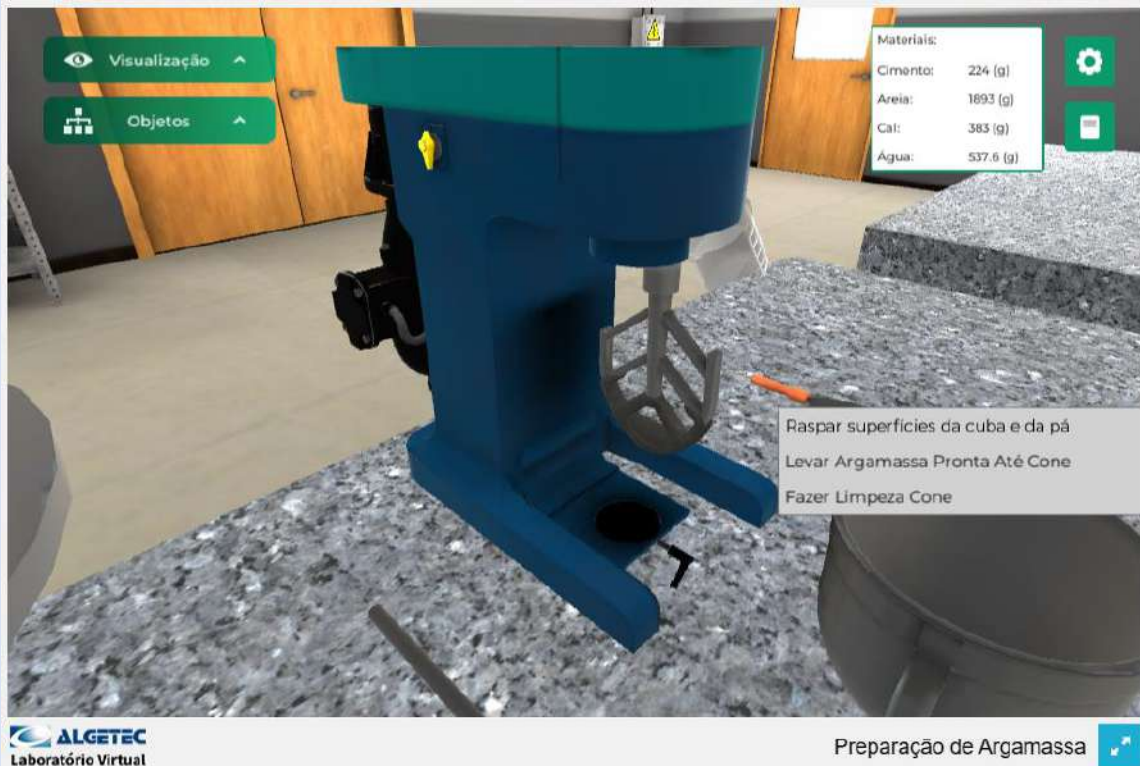
Figura 12 – Uso da espátula no ensaio de consistência.
